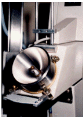
Foto 7. Elipsoide del tripter X1 mostrando la bujía, mira del elipsoide y señalador delgado para alineación
