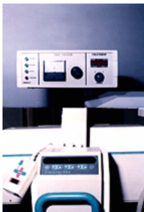
Foto 24: Consola de mando para Digiscope.Consola para control de la onda de choque.Modelo Compact.
