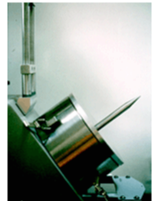
Foto 13: Señalador grueso de alineación. En la plataforma del elipsoide, fija 4 tornillos, puede verse en la mira que permite escoger el punto focal 2
