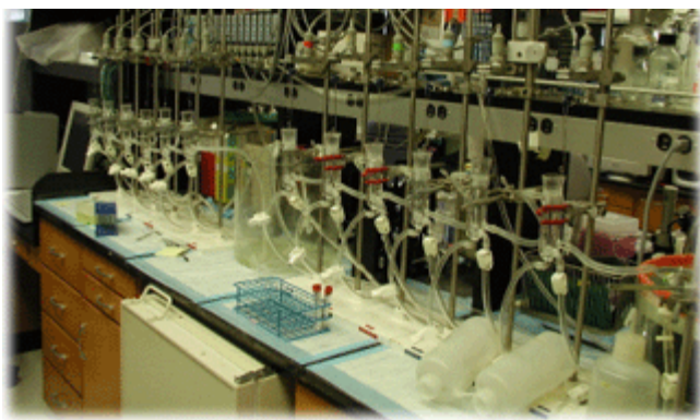
Figura 5: Aparato de bioensayo en cascada acoplado a un sistema de adquisición de datos computarizado
